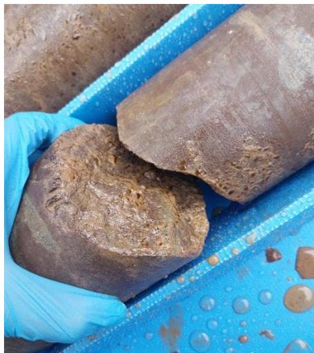
Figura 30. Testigos de 7,1 a 8,8 m. Se señalan las fracturas con presencia de fase
