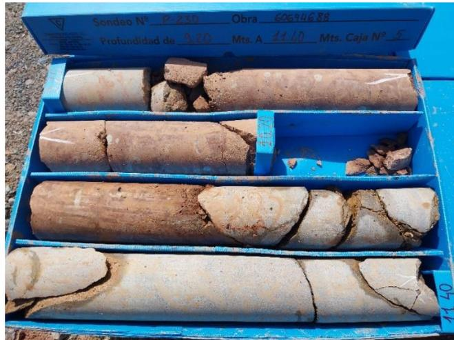
Las fracturas se dividen en familias de <math><20^\circ</math>, <math>30-45^\circ</math> y <math>80^\circ</math>, siendo la mayoría de ellas de menos de 1-2 mm de espesor. Se han detectado varias fracturas afectadas por fase libre, a destacar una de 2 mm a 13,9 m y otra de 1 mm a 22 m de profundidad.
