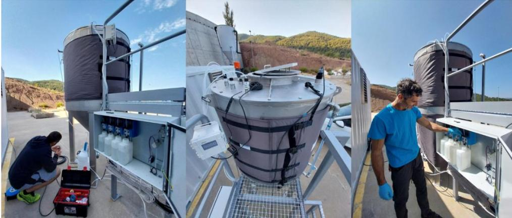
El sistema se compone de un depósito principal de un volumen de unos 2.000 l en el que tiene lugar el tratamiento biológico. Este depósito dispone de una entrada que recoge el agua contaminada procedente del acuífero y una salida para evacuar el efluente tratado. En el [Anexo D](#) se muestra un plano del mismo.
