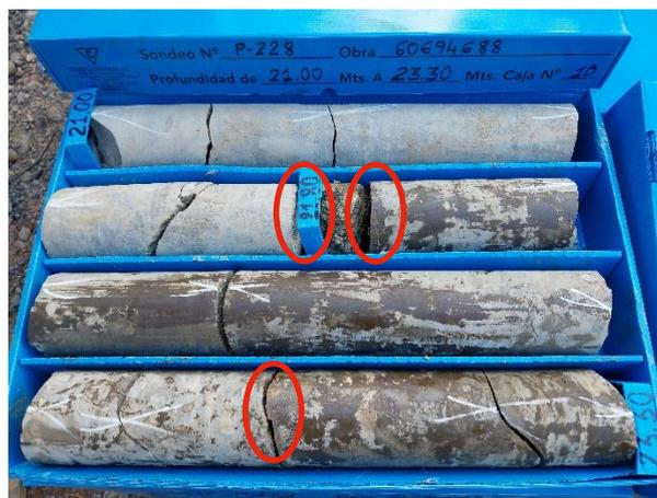
Tras pasar el tramo de materiales de relleno y cortar la capa M, se produjo la pérdida total del agua inyectada para la perforación, entre los 4,6 y 4,7 m de profundidad. Este comportamiento se repite en el resto de las perforaciones realizadas en la capa M.
