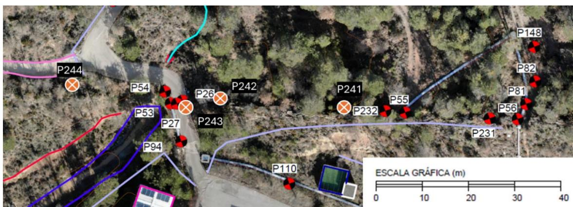
Todos los sondeos se han perforado con batería doble de 116 mm de diámetro, con corona de diamante y recuperación de testigo continuo, y posteriormente se han reperforado a 146 mm para una correcta instalación con tubería piezométrica de 4". Los sondeos ubicados aguas arriba del fondo del barranco 3 alcanzaron una profundidad cercana a los 18 m mientras que el sondeo perforado aguas abajo alcanzó los 30 m.
