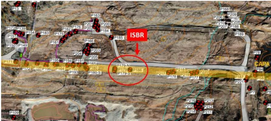
El objetivo del ensayo era intentar bioestimular el metabolismo microbiano por vía anaeróbica en esta zona del acuífero y favorecer la degradación de los contaminantes de interés. Para ello, se instaló un dispositivo que permitía inducir unas condiciones anaeróbicas controladas mediante la inyección de nitrógeno y lactato sódico al 20% como dador de electrones.
