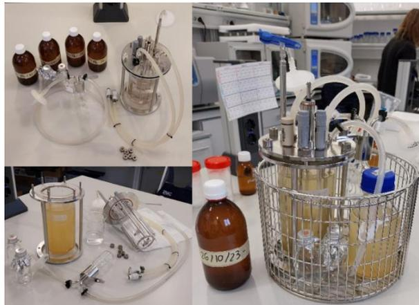
Siguiendo el objetivo descrito, el condensador del MiniBio trabajó a un 100%, y la concentración de oxígeno disuelto se fijó en un 60% sin inyección de oxígeno, solo con una baja agitación. La temperatura elegida fue 25°C, por ser a la que se trabaja habitualmente.
