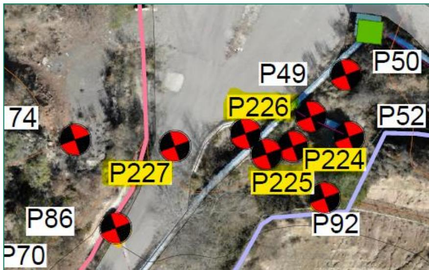
Todos los sondeos se han perforado con batería doble de 116 mm de diámetro, con corona de diamante y recuperación de testigo continuo. En los cuatro sondeos se ha reperforado un tramo inicial con batería de 131 mm para equipar con boquilla de acero y proteger el sondeo, evitando posibles desprendimientos.
