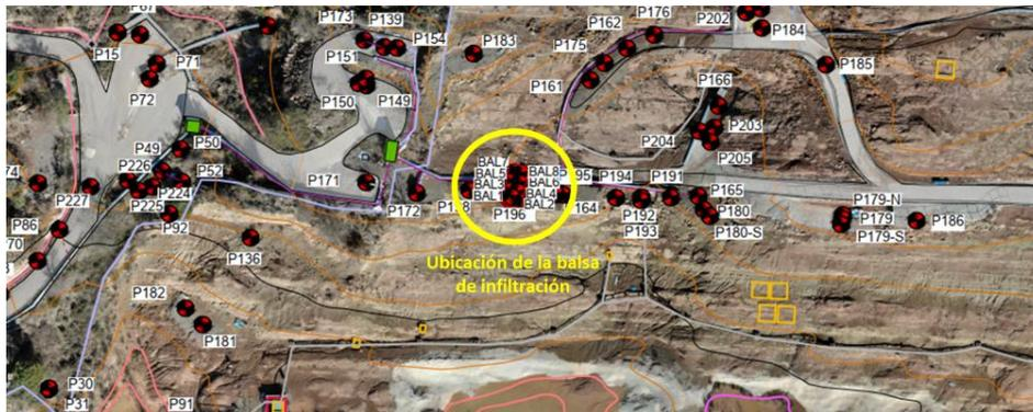
Figura 30. Distribución de los sondeos de actuación en la balsa (vista general y detalle)
