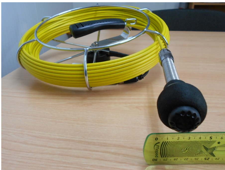
Foto. Videocámara utilizada en la inspección de los pozos de goteo.
